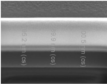
图 8 白 Mura 不良 FIB 结果-1 Fig.8 Result of white Mura by FIB-1
